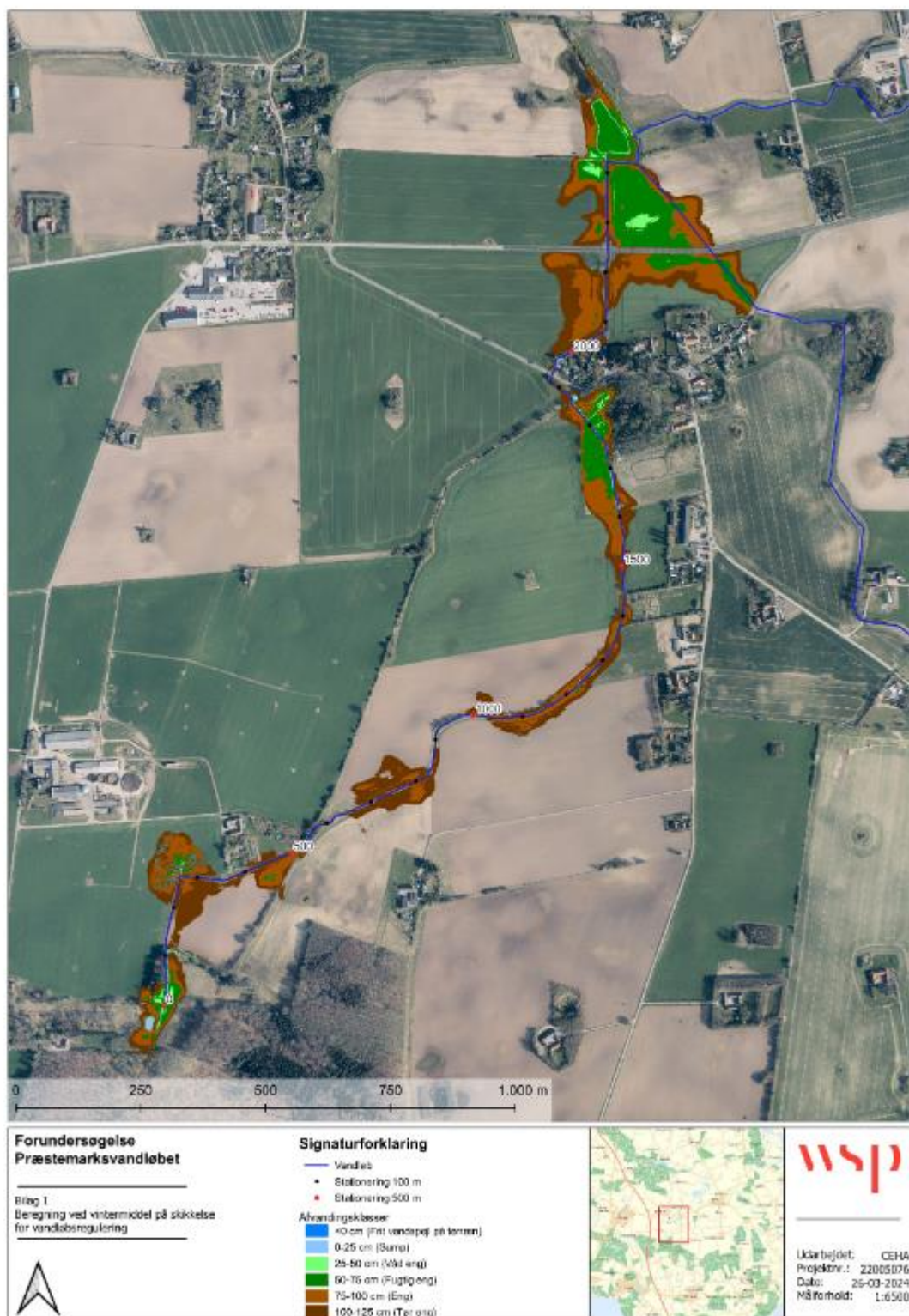
Figur 7. Viser afvandingsforholdene ved en vintermiddel ved de nuværende forhold.
